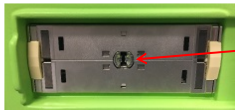
Kuva 7: Anturin liitäntäpaikan lukitusura
